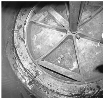
Da führt kein Weg vorbei – für die Wartung des Gebläsezylinders muss „einer“ hinein. Das können nur sehr schlanke Helfer, wie Friedrich Körner, der Sohn des Schmiedemeisters und Restaurators Bernhard Körner aus Finsterwalde. Allerdings will der Neuntklässler kein Schmied, sondern Musiker werden. Links der Blick in den Zylinder mit dem gusseisernen Stempel und Eichenring, der das Büffelleder hält Fotos: Ha.
