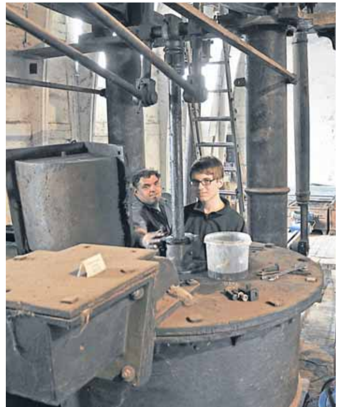
Da führt kein Weg vorbei – für die Wartung des Gebläsezylinders muss „einer“ hinein. Das können nur sehr schlanke Helfer, wie Friedrich Körner, der Sohn des Schmiedemeisters und Restaurators Bernhard Körner aus Finsterwalde. Allerdings will der Neuntklässler kein Schmied, sondern Musiker werden. Links der Blick in den Zylinder mit dem gusseisernen Stempel und Eichenring, der das Büffelleder hält Fotos: Ha.
