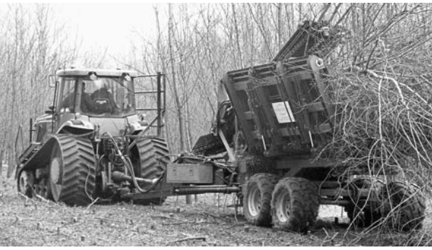
Harte Robinie zu ernten verlangt robuste Technik. Doch die ist teuer und lohnt wirtschaftlich erst bei großen Flächen, die es (noch) nicht gibt. Oben: Sogenannte Felddräcker kamen bei den ersten Ernten zum Einsatz. Die Maschinen benötigen jedoch klare Wuchserien wie auch die Vollbaum-Erntemaschine (Foto links). Ihr Vorteil ist es, dass die Bäume aufgetürmt im Freien weiter trocknen können. Dafür ist jedoch ein zweiter Anlauf zum Häckseln und Abtransportieren notwendig. In diesem Jahr soll eine dritte Variante mit einem Forstmulcher getestet werden. Gesucht werden gleichzeitig Abnehmer für das wertvolle Brennmaterial Fotos: C. Böhm / Vattenfall
