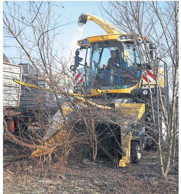
Harte Robinie zu ernten verlangt robuste Technik. Doch die ist teuer und lohnt wirtschaftlich erst bei großen Flächen, die es (noch) nicht gibt. Oben: Sogenannte Felddräcker kamen bei den ersten Ernten zum Einsatz. Die Maschinen benötigen jedoch klare Wuchserien wie auch die Vollbaum-Erntemaschine (Foto links). Ihr Vorteil ist es, dass die Bäume aufgetürmt im Freien weiter trocknen können. Dafür ist jedoch ein zweiter Anlauf zum Häckseln und Abtransportieren notwendig. In diesem Jahr soll eine dritte Variante mit einem Forstmulcher getestet werden. Gesucht werden gleichzeitig Abnehmer für das wertvolle Brennmaterial Fotos: C. Böhm / Vattenfall
