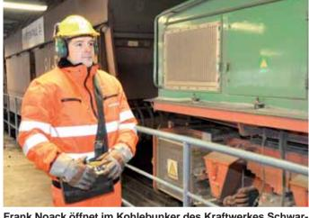
Frank Noack öffnet im Kohlebunker des Kraftwerkes Schwarze Pumpe jeden Waggon von Hand. Den Zug "verschiebt" er per Fernbedienung, damit nur leere Schächte befüllt werden
