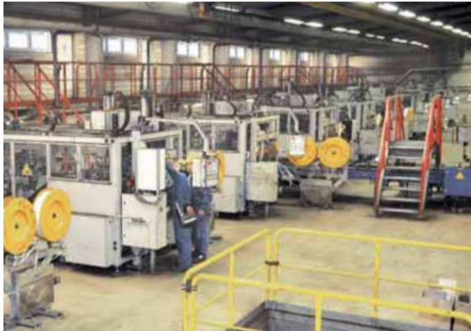
Das andere „Ende“ der 19 schier endlosen Brikettstränge: An diesen Maschinen werden die abgekühlten Briketts vollautomatisch abgepackt. Per Gabelstapler kommen die Paletten in die Lagerhallen, die etwa eine sechsmontatige Produktionsmenge (April bis September) fassen können. Damit können die Verkaufsstellen auch in anhaltenden Stoßzeiten im Winter problemlos beliefert werden
