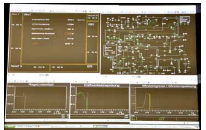
Das Überwachungsbild eines Stromnetz-Zusammenbruchs - auch und besonders der Störfall in vielen hundert Varianten wird im „GridLab“ trainiert. Denn im Ernstfall muss jeder Handgriff sitzen, um die Regionen schnell wieder mit Energie versorgen zu können. Verschiedene Netzsysteme können hier optisch identisch und unter realistischen Bedingungen wie in der echten Schaltwarte nachgebildet werden
