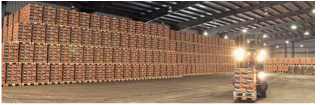
Das andere „Ende“ der 19 schier endlosen Brikettstränge: An diesen Maschinen werden die abgekühlten Briketts vollautomatisch abgepackt. Per Gabelstapler kommen die Paletten in die Lagerhallen, die etwa eine sechsmontatige Produktionsmenge (April bis September) fassen können. Damit können die Verkaufsstellen auch in anhaltenden Stoßzeiten im Winter problemlos beliefert werden
