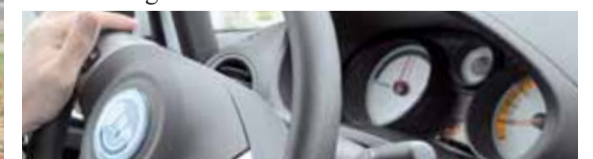
Am dkw befindet sich eine Säule mit zwei Ladepunkten. Leider wird sie oft zugesperrt. Die Anzeige im Opel Cetos ist spartanisch. Der linke Zeiger zeigt den Stromverbrauch und die Rückladung durch die Bremse an. Digital sind Reichweite und Stromfluss ablesbar
