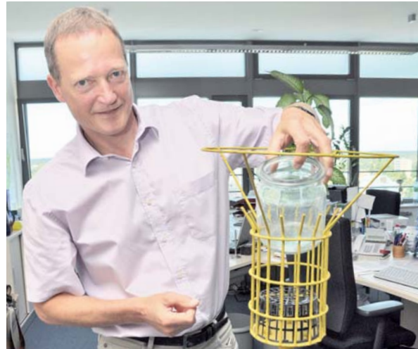
Mit diesem simplen Glas misst Jens Höhna die Staubmengen an 63 Stellen rund um die Tagebaue. Der Käfig hält Vögel auf Abstand. Meistens sind die Milligramm-Staubmengen im Regenwasser „versunken“. Ein Labor untersucht monatlich die Proben dieser „Berghoff-Messgeräte“ Foto: J. Ha.
