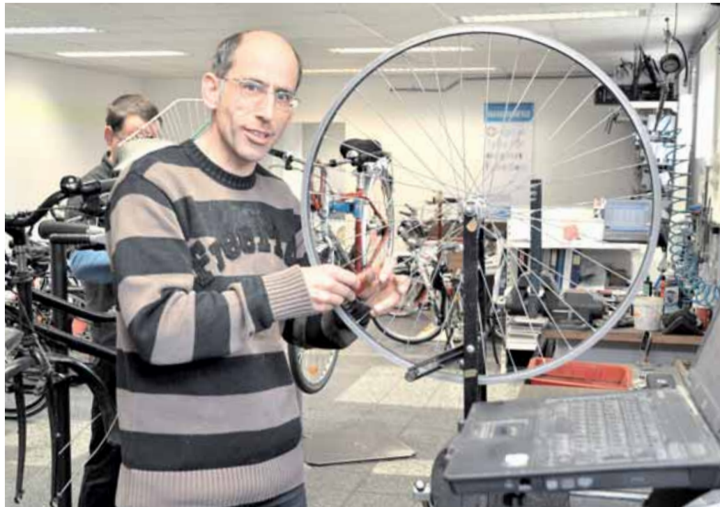
Zweirad-Mechaniker-Meister Axel Schulrath legt beim Spannen der Speichen genauso große Sorgfalt an den Tag, wie beim Auslesen und Reparieren der Steuerungselektronik von E-Bikes. Fahrräder enthalten mehr Teile, die höchsten Beanspruchungen ausgesetzt sind, als den Pedaleuren bekannt ist, sagt der Meister. Dazu gehören auch die Speichen. Bauen sich Schwingungen auf, können sie auf gerader Strecke reißen - kein Vergnügen für den Radler. Bei allen Arbeiten steht deshalb die Sicherheit an oberster Stelle
