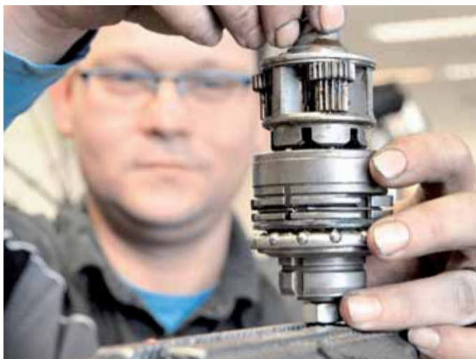
Geheimnisvoll: Zweiradmechaniker Maik Blankenhagen zieht das Planetengetriebe einer Fünfgang-Getriebebox aus dem Hohlrad. Bei dieser Bauform muss das Getriebe alle zwei Jahre neu gefettet werden, weil die verharzenden Fette das Schalten immer mehr erschweren Fotos: Jens Haberland
