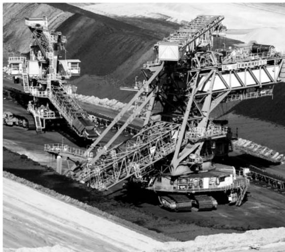
**Während die Eimerkettenbagger, die direkt an die F60 angeschlossen waren, einer umfangreichen Sanierung unterzogen wurden und werden, arbeiten die Schaufelradbagger (Foto) auf Hochtouren und versorgen das Kraftwerk Schwarze Pumpe weiter mit dem Rohstoff**
