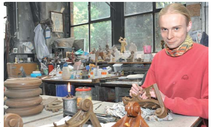
Seit einem Monat lernt der Zittauer Georg Baumann den Beruf des Metall- und Glockengießers mit der Spezialisierung Wachsformer. Die Wachpositive werden mit Silikon-Formen der Vorlagen gefertigt. Erst jetzt wird die Sandform in mindestens acht Lagen „aufpaniert“. Beim Brennen läuft das Wachs aus und schafft Platz fürs Metall
