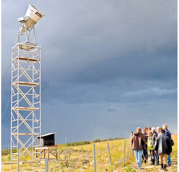
Eines von mehreren „merkwürdigen“ Messgeräten auf der Tour durch den Tagebau Welzow-Süd: Die Besuchergruppe steht am Radiometer, einem aus Zürich erworbenen Gerät, das über Langwellenstrahlung auf einer großen Fläche Temperatur und Wassergehalt an der Bodenfläche misst Foto: RF
