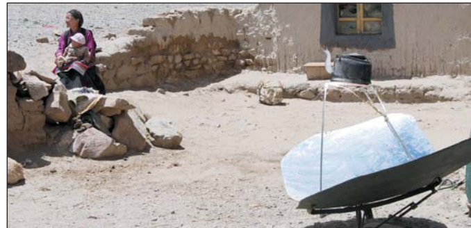
Im Brennpunkt des Parabolblechs kommt das Wasser im Teekessel hier oben schon bei 80 Grad zum Sieden
