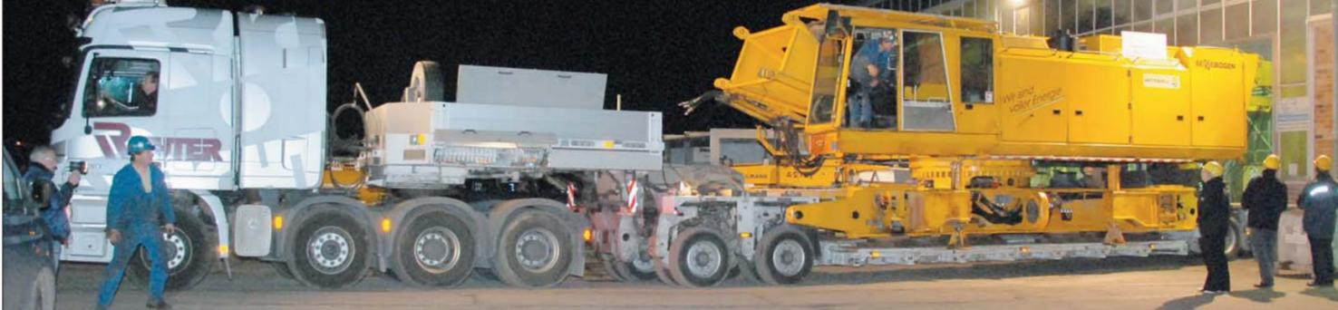
Unter dem Dach der riesigen Werkhalle der Welzower Bohrgeräteservice-Firma L&S GmbH türmt sich das Herzstück des Dichtwand-Schlitzfräsegerätes hinauf, nun muss es nach nur gut vierwöchiger Generalüberholung wieder durchs Tor und zum Tagebau Reichwalde, wo es schon ab 4. Dezember eine neue, grundwasserschützende Dichtwand schlitzten wird. Federleicht stemmt sich der 65 Ton-
