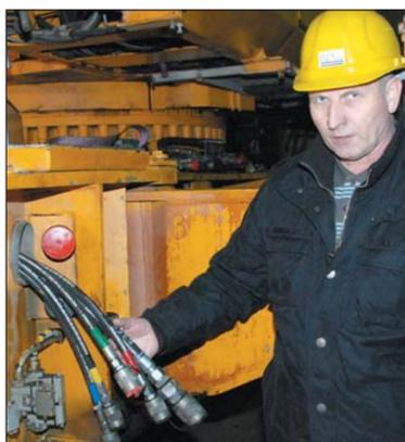
kte bei mehreren Mitarbeitern Emotionen, denn sie haben einst - noch unter Laubag-Flagge - das Gerät selbst mit erbaut. Hydraulikschläuche, -pumpen, die Elektronik und Elektrik wurden erneuert, sämtliche Verschleißteile ausgetauscht. „Jeder Hydraulikschlauch ist eine Einzelanfertigung.“ Bis zu 20 Zentimeter im Durchmesser messen
