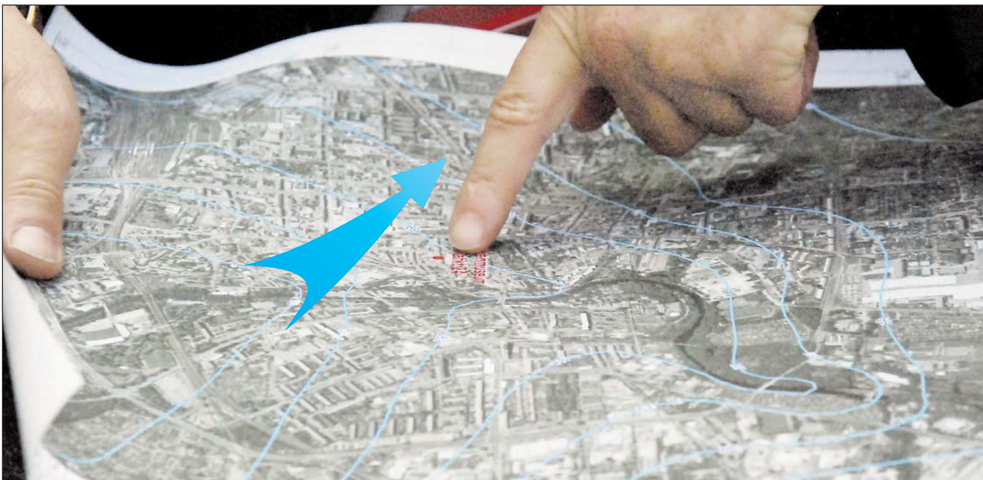
Als Pegelstelle 500 181 (roter Punkt) ist der alte Brunnen auf dem Hof des Apothekenmuseums im umfangreichen Messwerk von Vattenfall aufgenommen worden und wird nun monatliche Daten liefern. Diese Karte zeigt außerdem den ungewöhnlichen Verlauf des Grundwassers (die hellblauen Tiefenlinien) in Bezug zur Spree. Aufgrund eiszeitlicher Gegebenheiten fließt die Spree auf einem „Hochbett“, das höher liegt als das Umland. Das Grundwasser fließt also nicht - wie eigentlich üblich - in den Fluss, stattdessen nimmt es direkt Kurs über Uni-Campus in Richtung Burg/Spreewald (Pfeil)
