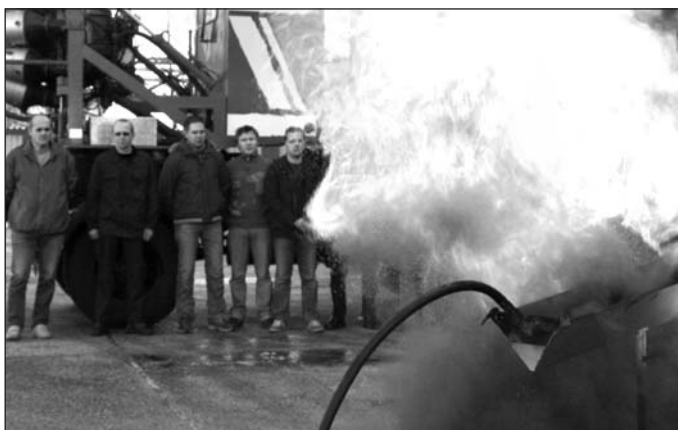
Der Explosionssimulator, den Lothar Hopka (li.) und Ulrich Wegner entwickelt haben, kann in jedem Pkw-Kofferraum transportiert werden. Er ist neben dem Braunkohlenbergbau auch in anderen Industriezweigen wie der Backwarenindustrie, der Holzverarbeitenden Industrie oder bei der Feuerwehr für Schulungszwecke einsetzbar. Besonders eindrucksvoll ist die Schnelligkeit der Brandausbreitung - anschauliche Unfallverhütung, die jetzt preisgekrönt wurde
