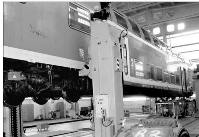
Der komplette Triebwagen oder gegebenenfalls auch die Lok wird angehoben und der Unterflurdrehautomat an die Achse herangefahren. Je nach Verschleißbild nimmt der Stahl zehn bis 20 Millimeter vom Radreifen ab. Drei solche Behandlungen sind möglich, dann wird der Radsatz komplett getauscht - für die nächsten Erdumrundungen Fotos: Hnr.
