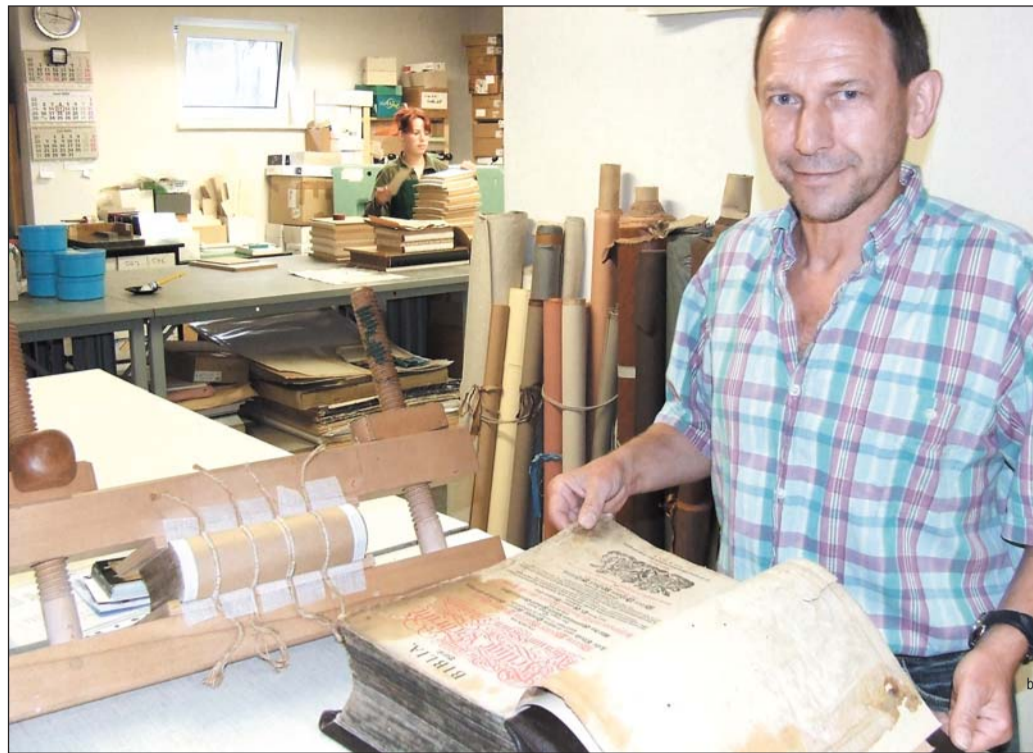
Eine Bibel aus dem Jahre 1710 ist jüngst in der Werkstatt von Reinhard Kußagk in der Gulbener Straße repariert worden. In der Heftlade sind alle rund 1 200 Seiten zunächst sorgsam zum Buchblock sortiert und geheftet, dann der Rücken auf erhabenen Bündeln gefügt worden. Von den Leinenrollen im Hintergrund werden die Bespannungen der Buchdeckel gefertigt, der Bibeleinband aber ist aus Leder
